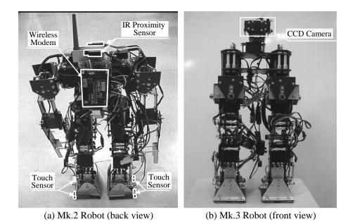
Fig. 6. Mk.2 and Mk.3 Robots
